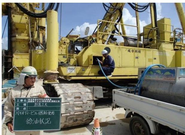
写真-9 BDF を使用している杭打ち機
