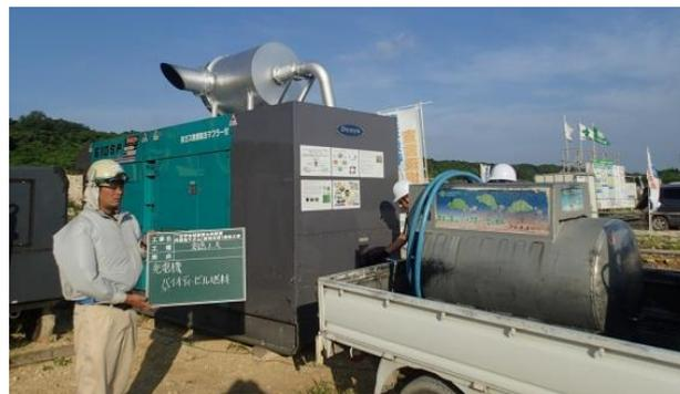
写真-10 BDF を使用している発電機
